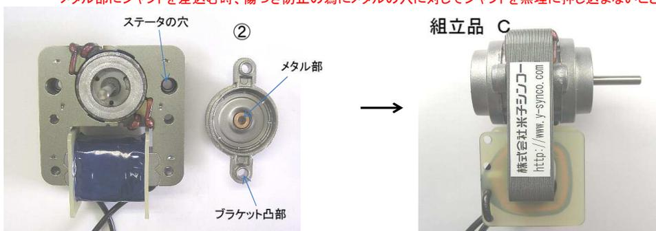
(チェックポイント) ブラケット内のメタル受けを支点に、メタルは押さえバネによりメタルがある程度左右方向に動くように設計されています。
