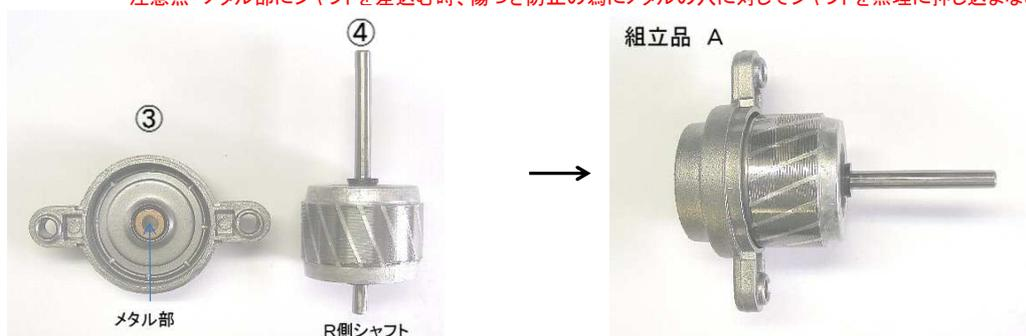
(チェックポイント) ブラケット内のメタル受けを支点に、メタルは押さえバネによりメタルがある程度左右方向に動くように設計されています。
